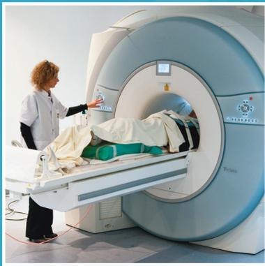
Spectromètre-imageur par résonance magnétique corps entier 3 teslas.
